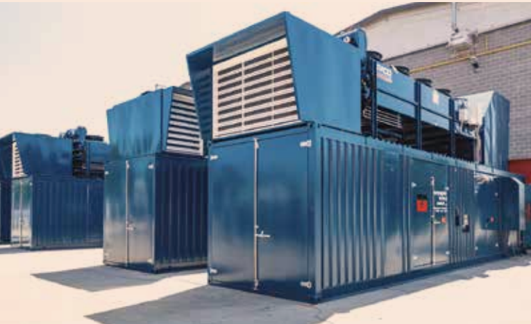
Collaudi di gruppi elettrogeni in fabbrica a Cesano Boscone prima della consegna
