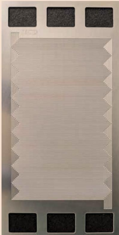
La fotoincisione consente di realizzare canali molto complessi sulle due facce delle piastre bipolari, in modo da ottimizzare la distribuzione di idrogeno e ossigeno e per l'eventuale raffreddamento in caso di alte densità di potenza
