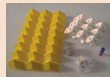
Esempi di tassellazioni origami: Eggbox, Kresling e Trimorph
