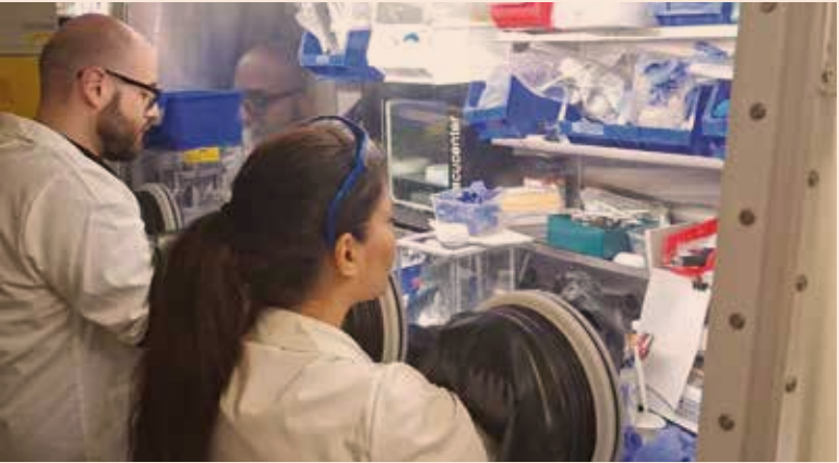
Il ricercatore Leonardo Balducci e Nasim Rashidi preparano l'elettrolita polimerico ibrido, componente chiave della batteria a stato solido
