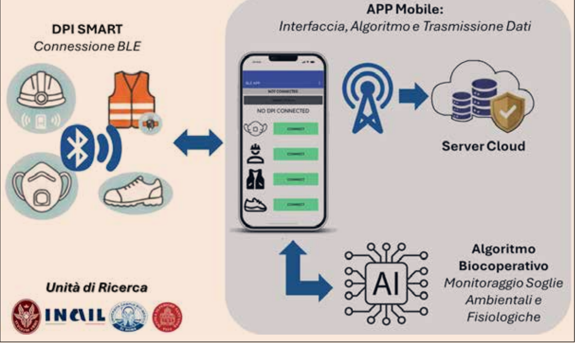
Sistema IoT Mobile per la gestione dei dispositivi da parte del lavoratore
