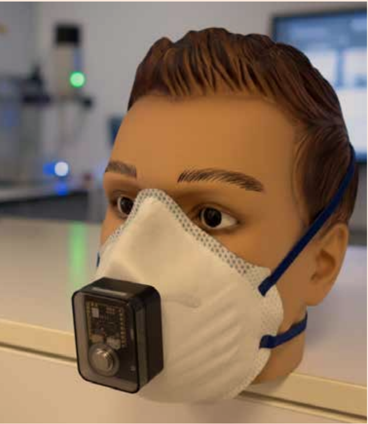
Mascherina FFP3 con sensoristica plug-in per il monitoraggio dell'affaticamento respiratorio e movimento
