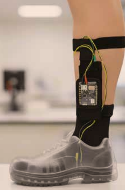
Cavigliera innovativa per il monitoraggio del microclima e di possibili cadute e/o scivolamenti
