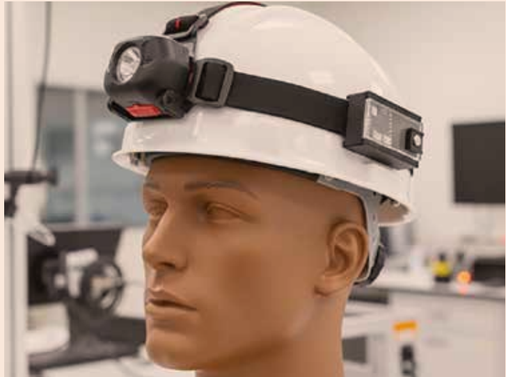
Casco di protezione con sensoristica per il monitoraggio ambientale e rischio di urti e cadute
