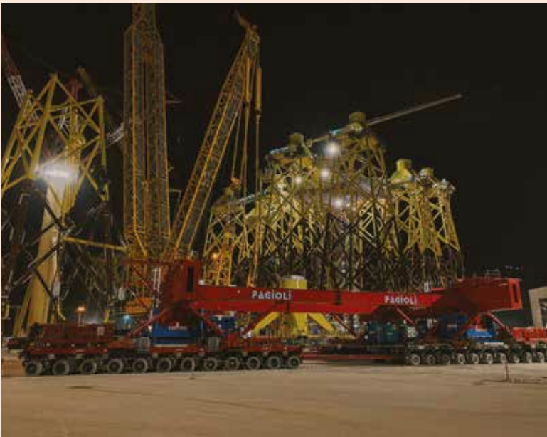
Il Jack-Up System, il sistema di sollevamento sviluppato ad hoc, che prevede quattro unità di sollevamento posizionate sotto ciascun angolo di carico
