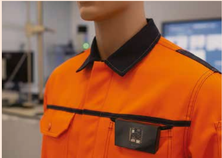
Badge per giacca di protezione per monitorare movimenti e possibili cadute con bracciale smart per il rischio elettrico
